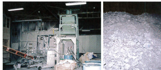
▲環美が誇る固化処理プラント。自社開発した安定固化剤(ジェット-P)により、トロトロだった廃塗料がサラサラの粒状になります(写真右)
